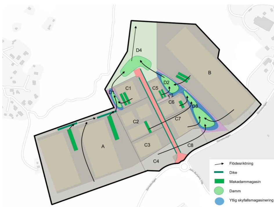
Bild 1 Principskiss över hur dagvatten och skyfallsanläggningar kan placeras för att möjliggöra erforderlig rening, och fördröjning och magasinering.
